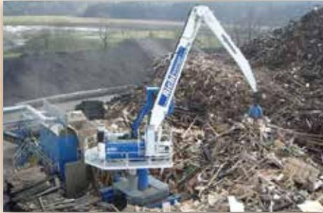
Der Sennebogen 830 Elektro bei der Beschickung von Altholz in das Biomassekraftwerk. Einsatzgewicht: 36 Tonnen
