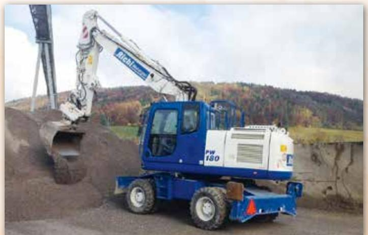
Der erste KOMATSU Radbagger im Einsatz. Die Allrounder-Maschine gilt als „Mädchen für alles“. Der extrabreite Unterwagen sorgt für Stabilität.
