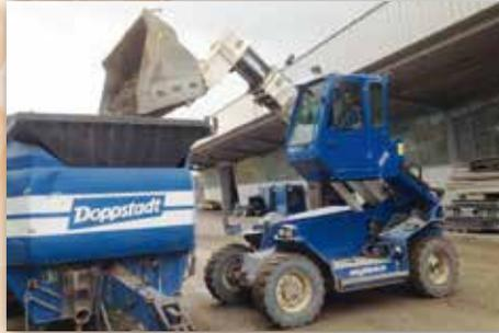
Großes Schaufelvolumen – hochfahrbare Kabine: der leistungsfähige 305 MH C+ von Sennebogen beim Aufgeben von Bauschutt.
